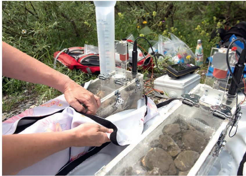
Ces boîtes contiennent de l'eau, des sédiments et de la matière organique. Recouvertes d'un tissu, elles permettent de mesurer le changement d'oxygène dissous par les organismes.
