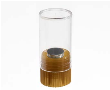
Ce « tampon noir » sert à récolter les résidus de poudre. La partie noire est un disque de carbone collant.
