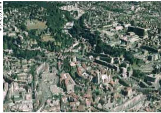
Cette image en perspective de la Cité de Lausanne est le résultat du drapage d'une photo aérienne (résolution : 50 cm, source : SwissTopo) sur un modèle numérique d'altitude laser (résolution : 1 m, source : SwissTopo). Le modèle laser, disponible sur l'ensemble du canton de Vaud, permet de reconnaître aisément le Palais de Rumine (en bas à gauche), la cathédrale (au centre) et le CHUV (en haut à droite). La photo aérienne est disponible pour l'ensemble de la Suisse.
