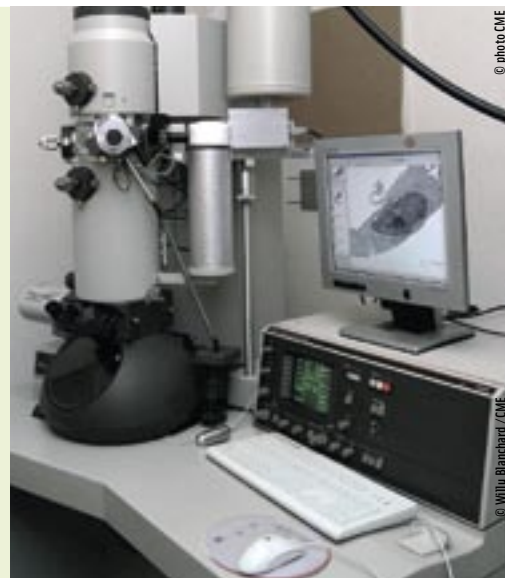
Vue partielle d'un microscope électronique à transmission équipé d'une caméra CCD et d'un détecteur de rayons X pour la microanalyse.
