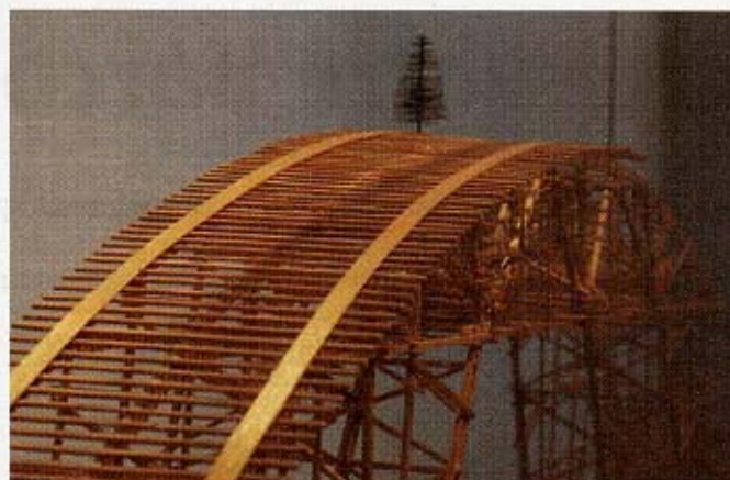
Maquette du cintre du pont de Gueuroz réalisé par Alexandre Sarrasin en 1932 (voir encadré). Un symbole du rapprochement entre les sciences humaines et techniques?
